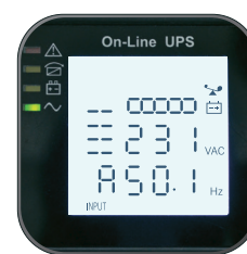
Контрольная панель силового модуля
