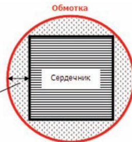
Круглое сечение обмоток
