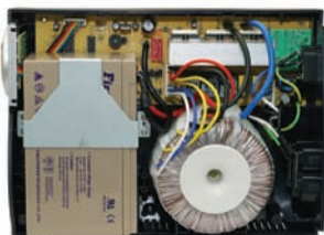
Высокоэффективный тороидальный трансформатор
