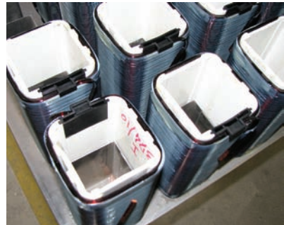
Квадратное сечение обмоток
