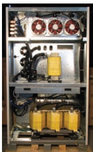
Задняя компоновка: изолир. трансформатор
