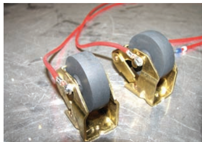
Новые износостойкие графитовые ролики со сроком службы свыше 10 лет
