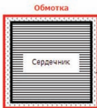
Квадратное сечение обмоток
